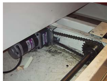
LOGICPlus™ Gearmotor monteret i Kasten Høvik mobilreol.
