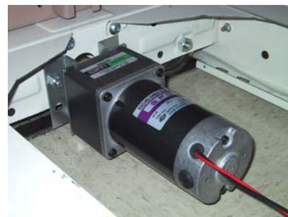
LOGICPlus™ Gearmotor monteret i NordPlan mobilreol.
